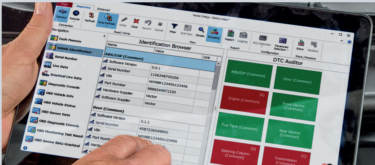
車両情報の確認:車載ECUについての一般的な情報をWindowsタブレットコンピューター上のIndigoで取得
