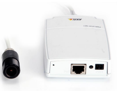
Bild 10: HostCAM: Sensoreinheit (links) und Hauptgerät (rechts)
