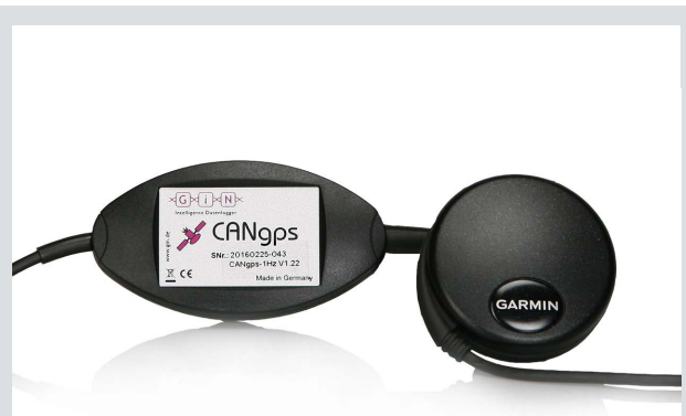
CANgps Aufzeichnen der Fahrzeugposition via GPS Für alle GL Logger; für die GL2000 Familie ist ein alternatives Modul verfügbar
