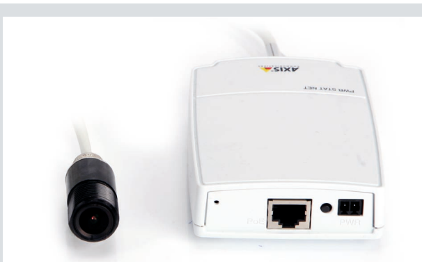
HostCAM Digitalkamera zum Aufzeichnen qualitativ hochwertiger Farbbilder Für GL3000/GL4000 Familien; für die GL5000 Familie ist zusätzlich die Kamera F44 verfügbar
