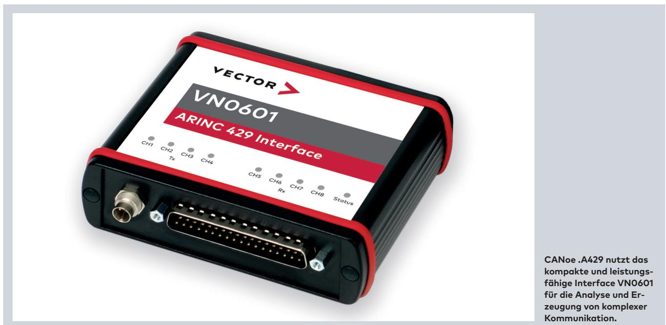
CANoe .A429 nutzt das kompakte und leistungsfähige Interface VN0601 für die Analyse und Erzeugung von komplexer Kommunikation.
