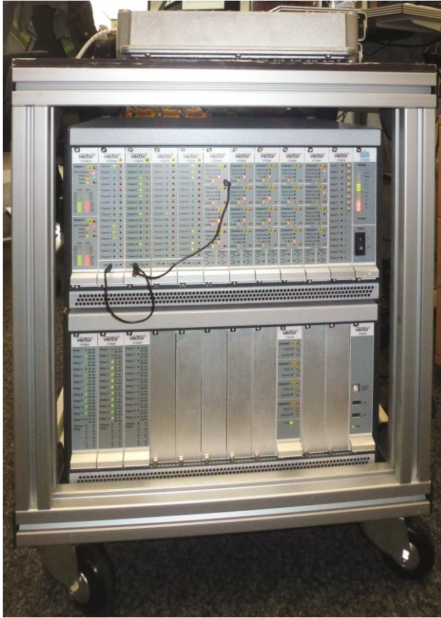
[그림 2: 벡터의 VT System 을 이용한 클래스의 ECU 전압 자극 및 측정 시스템]
