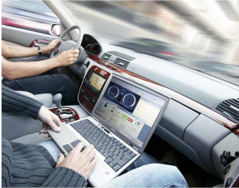
그림 2: 전문가용 네트워크 개발 툴인 CANoe로 진단 기능 테스트
