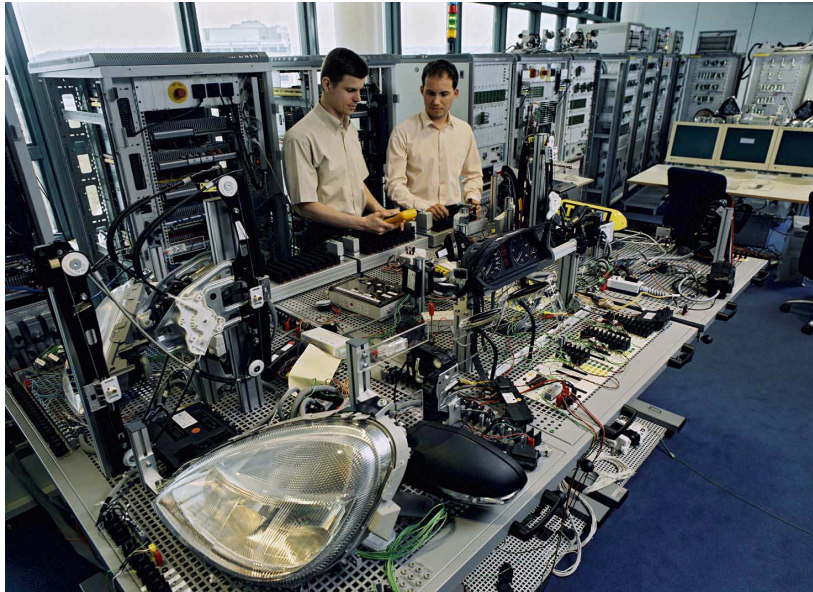
그림 3: 통합 테스트 벤치를 사용한 A 클래스 차량의 전자 부품 테스트
