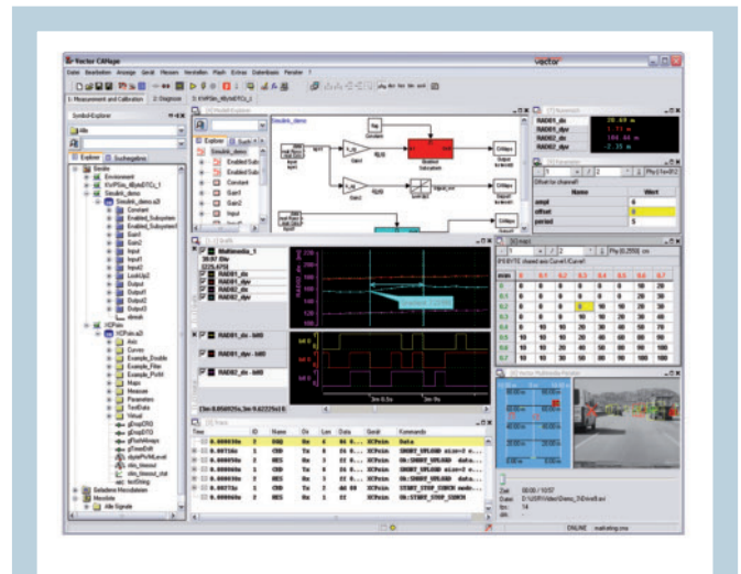
Bild 1: Zeitsynchrone Echtzeiterfassung und Visualisierung von steuengeräte-internen Signalen mit CCP/XCP, von Signalen aus CAN-, LIN- und FlexRay-Bussen sowie externer Messtechnik mit CANape. (Alle Bilder: Vector Informatik)
